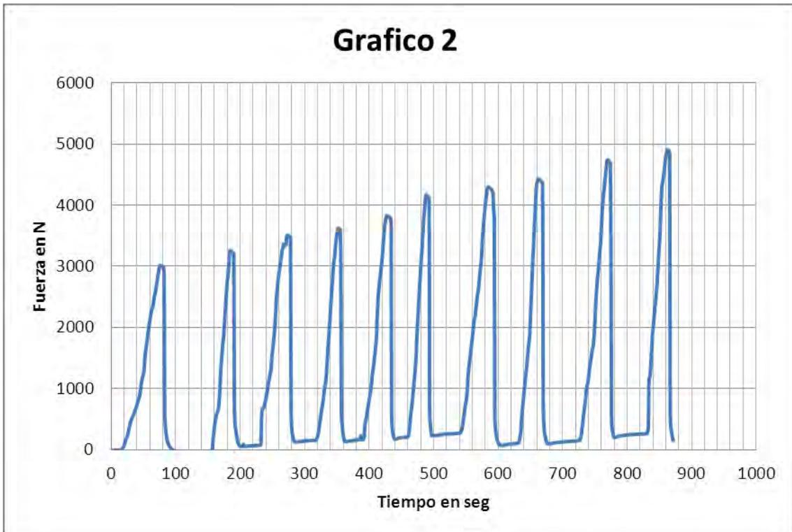
Gráfico 2: Carga – Tiempo en el ensayo 2
