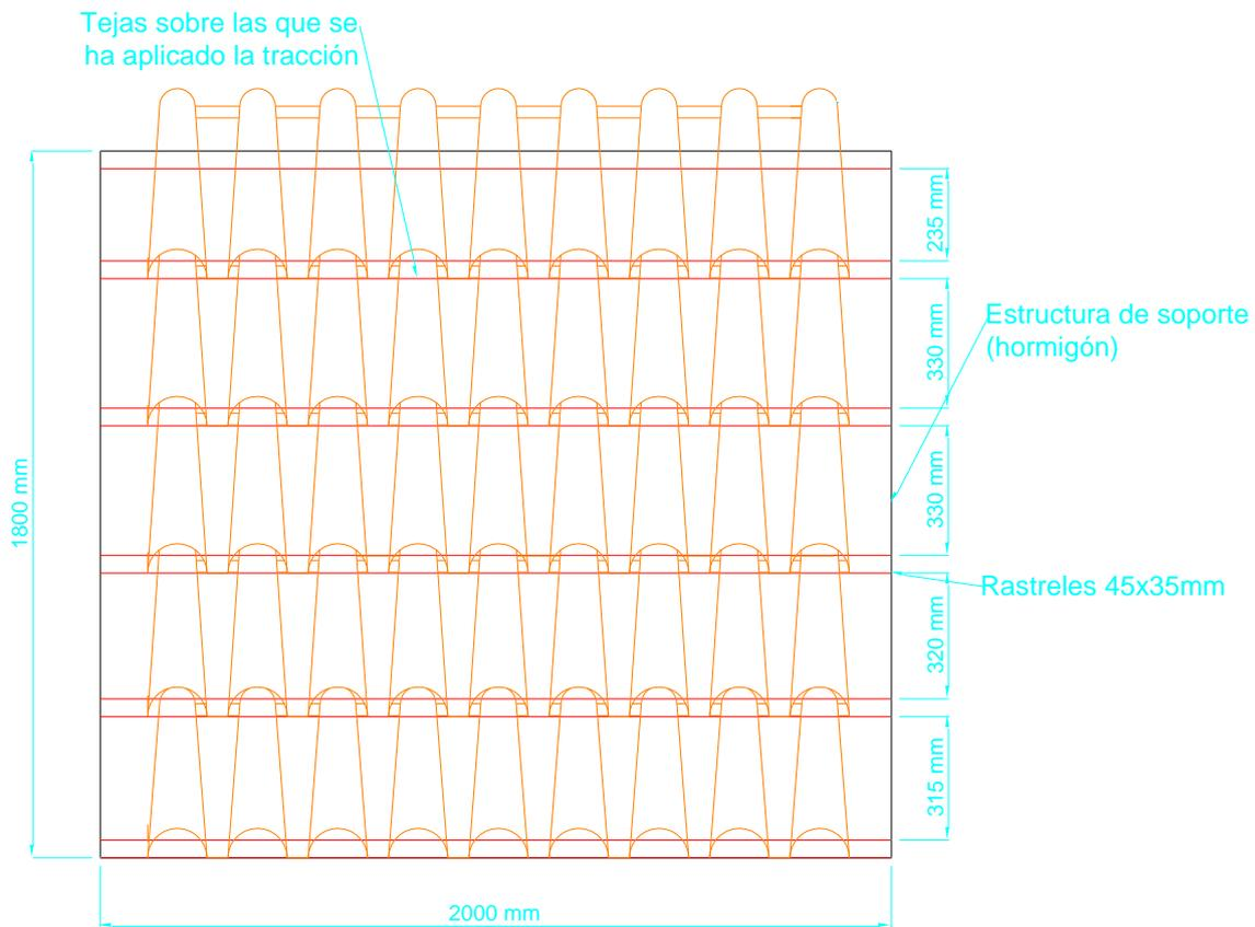
Figura 1: planta con la disposición de las tejas
