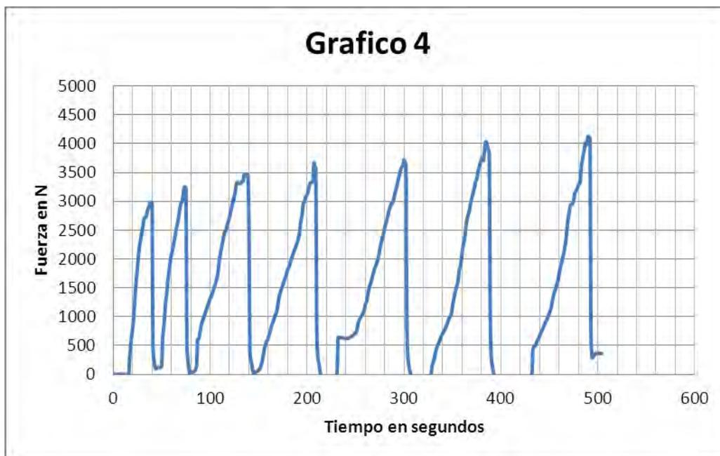
Gráfico 4: Carga – Tiempo en el ensayo 4
