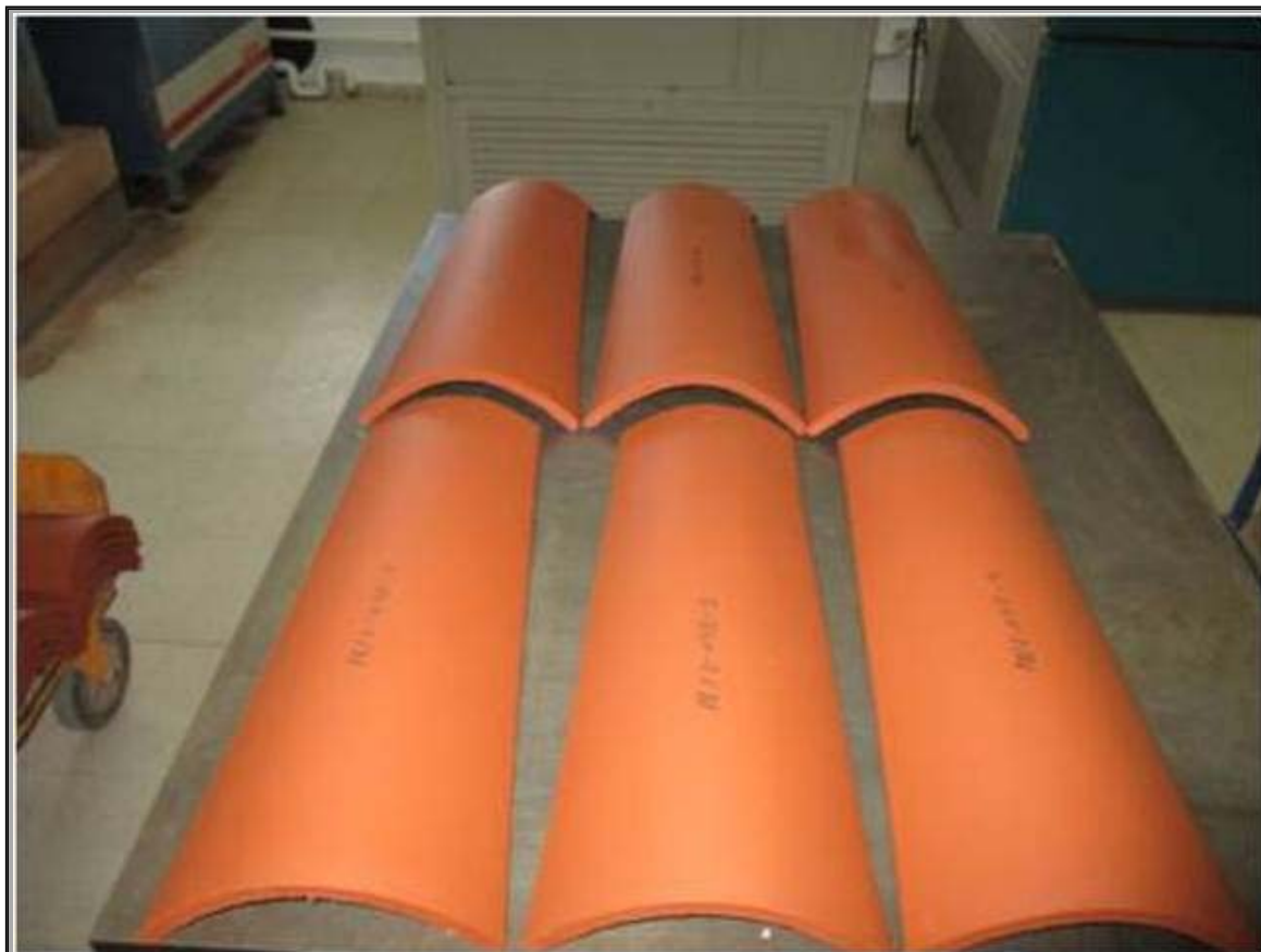
Fotografía 1: Aspecto de las probetas después de 500 ciclos de hielo
