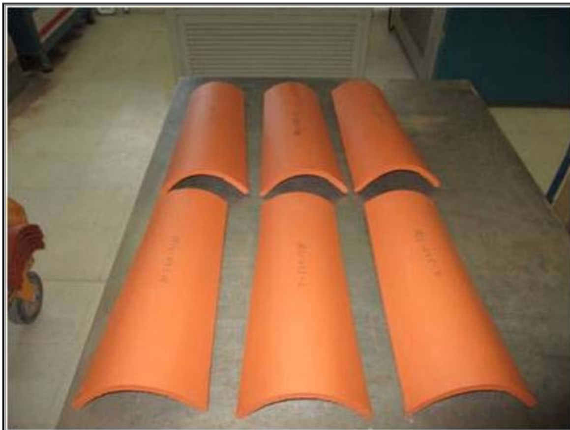
Fotografía 1: Aspecto de las tejas después de 500 ciclos de heladicidad
