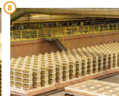
**Cocción** de la teja en horno túnel
